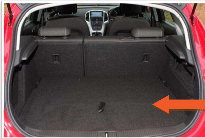
Doppelboden in erhöhter Position
