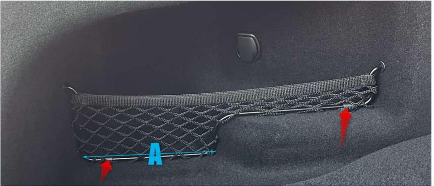
1. Lösen Sie den Metallrahmen von den beiden Clips, indem Sie jeden Clip festhalten und den Rahmen in die Aussparung schieben (siehe rote Pfeile)
