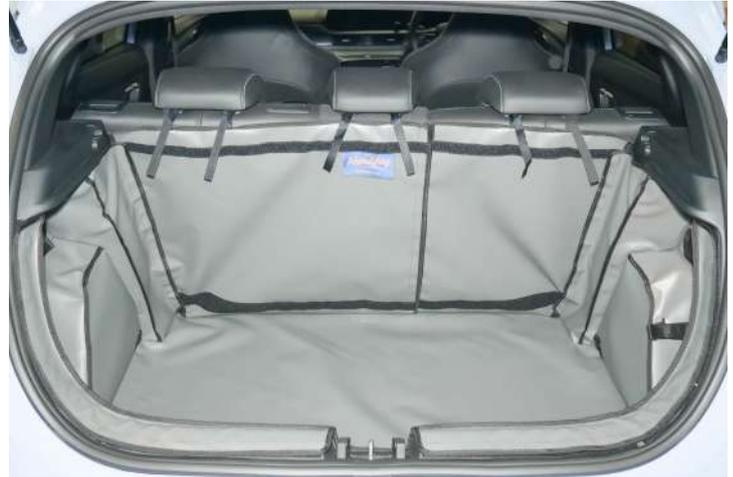
SH1- FNO- Bild zeigt Kofferraumschutz mit geteiltem Rücksitz, vorbereitet für Stoßtangenschutz, Rücksitzschoner und Verlängerung der Kofferraumauskleidung
