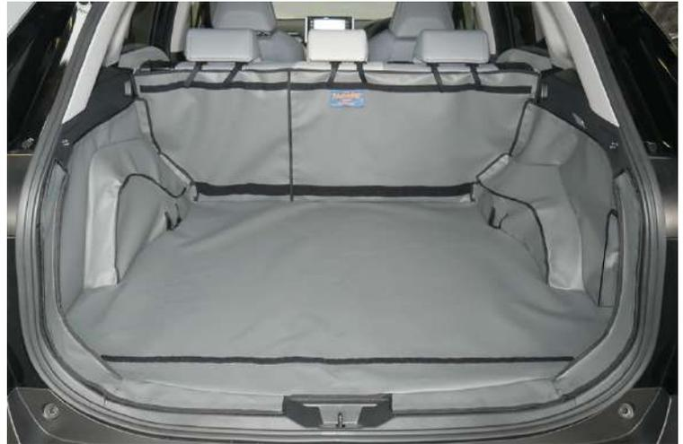
Bild zeigt Kofferraumschutz mit geteiltem Rücksitz und Zurrösenzugang, vorbereitet für Stoßstangenschutz, Rücksitzschoner und Verlängerung der Kofferraumauskleidung
