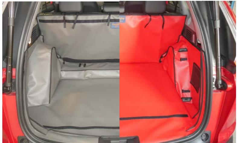
**Links:** Rücksitz Plus, vorbereitet für Verlängerung der Auskleidung, Rücksitzschoner und Stoßtangenschutz Bodenhöhe: FLOW
