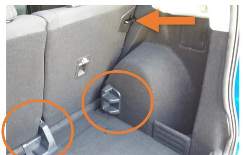
Kunststoff Fassungen & umgebaute Sitzverriegelung mit D-Ring Vorrichtung
