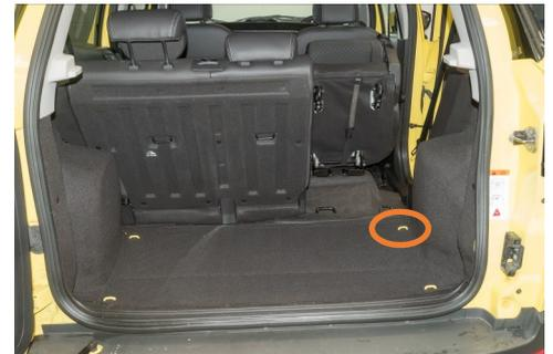
Ohne doppelte Boden und ausgesetzte 'D' Ringe
