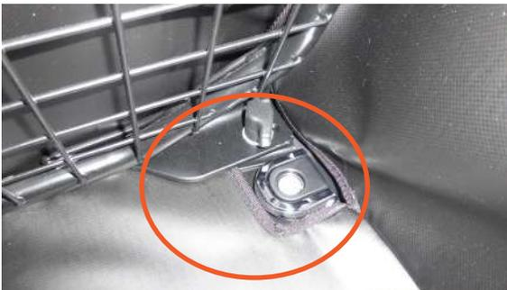
1. Die Auskleidung hat Ausnehmungen für die Halterungen, die an den Verzurrösen befestigt werden
