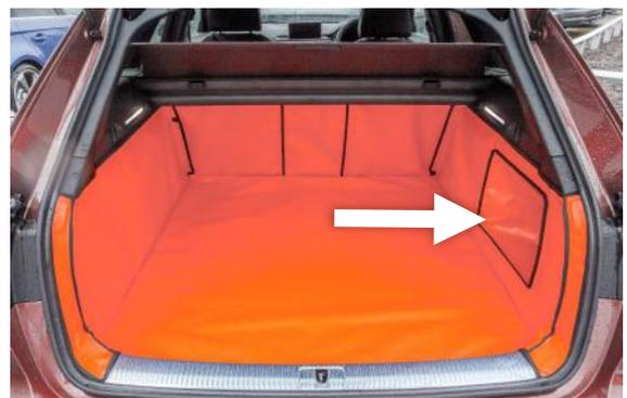
Das Netz muss abgesenkt werden, bevor Sie die Kofferraumauskleidung einbauen.
