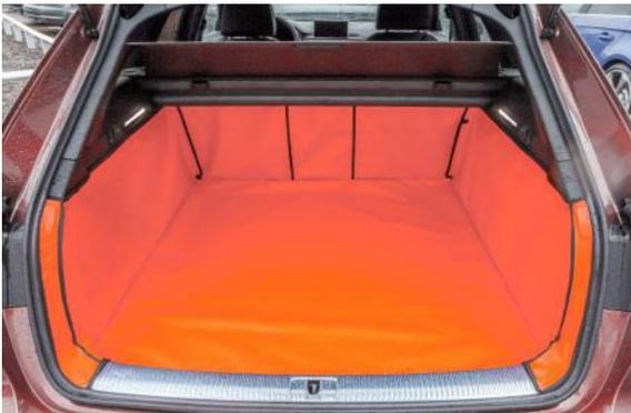
Um die Netze zu benützen, müssen die Seitenteile der Kofferraumauskleidung vorübergehend abgenommen werden.
