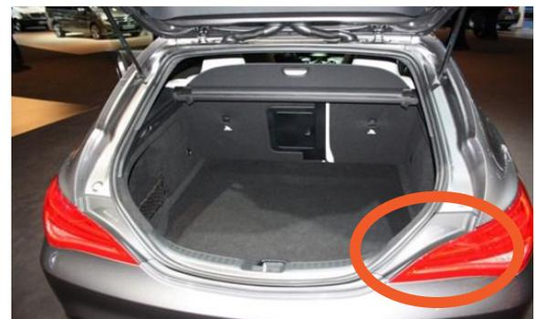
Kleinere Öffnung: Alle Rücklichter sind noch sichtbar, wenn die Heckklappe geöffnet ist
