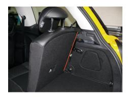
• Entfernen Sie die Kassette der Laderaumabdeckung/Hutablage. Diese kann später wieder eingesetzt werden.
