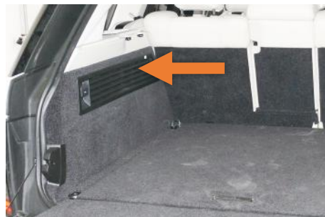
Entlüftung auf der Fahrerseite
