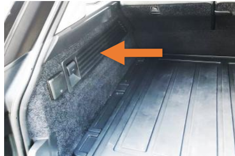
Entlüftung auf der Fahrerseite
