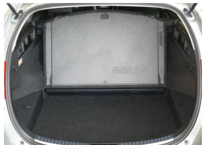
Sicht unter der Doppelbodenplatte - zeigt Lagerraum und der Standardboden.
